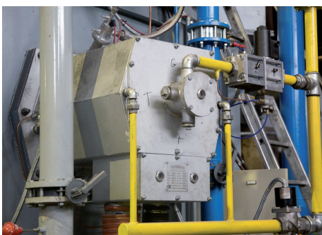
REGFIRE®-Brenner an einem Dreh- herdofen zum Schmieden von Ringen Горелки REGFIRE® на карусельной печи для ковки колец подшипника
